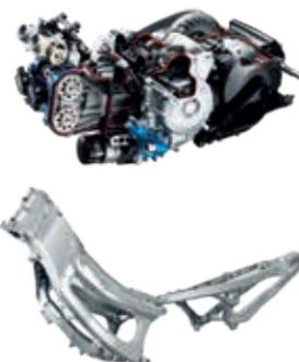
Der Hightech Motor ist das Herzstück des AK 550i ABS mit Cross-Plane Zündfolge und 550 ccm Aggregat. Die Basis dafür bietet der extrem leichte Aluminium-Brückenrahmen.
